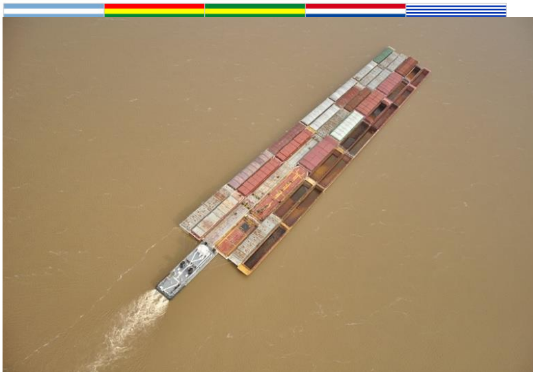
Figura 2 – Tren de barcazas tolva en formación 7x6
