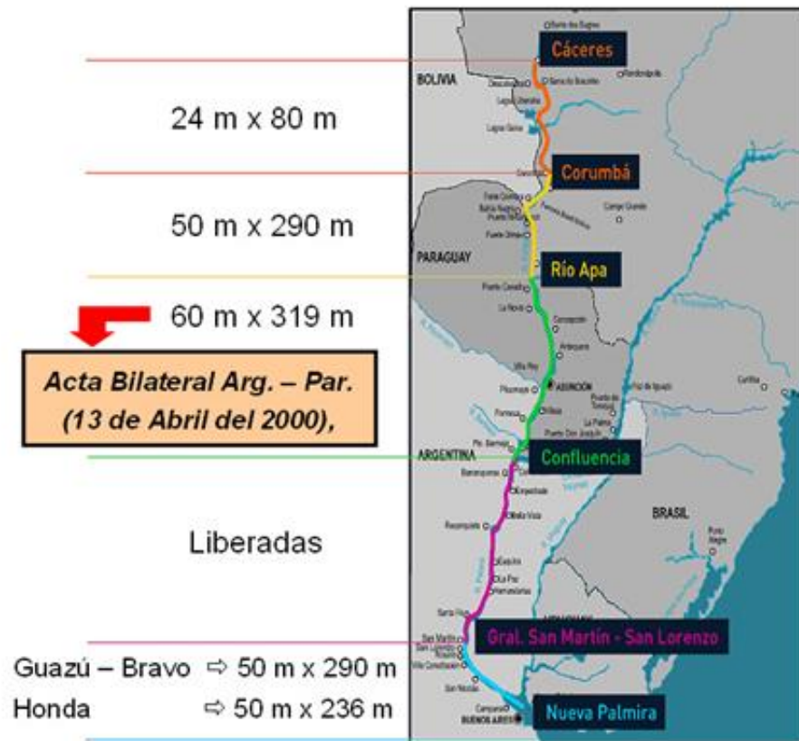
Figura 6.1–2. Tramos de la Hidrovía en función de las dimensiones máximas del tren de barcazas
