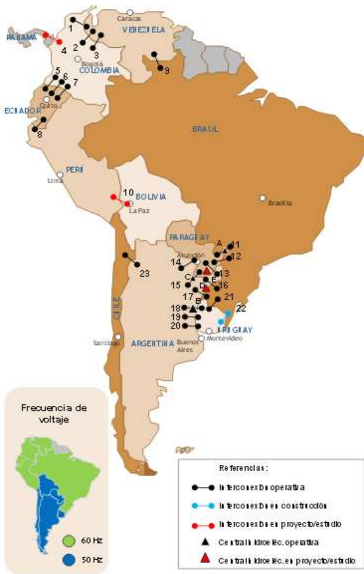
(A) UHE Itaipu, (B) UHE Salto Grande, (C) Yacyretá, (D) Garabí, (E) Corpus Figura 2 – Centrais elétricas e interligações elétricas dos sistemas de transmissão existentes entre os países da América Latina
