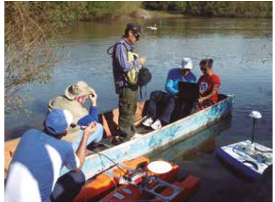
Medición del caudal del río Cuareim/Quaraí, mediante los medidores acústicos de tipo ADCP y M9 basados en el efecto doppler , durante taller de capacitación.
