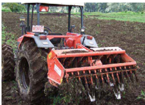
Maquinarias agrícolas que minimizan su impacto de uso en la degradación del suelo (izq.) Palín para la preparación de suelos. Maquinaria para la siembra directa (der.).
