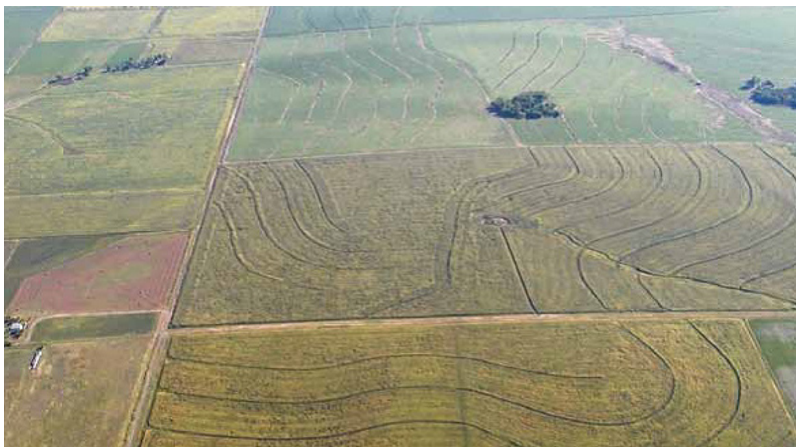
Disposición de terrazas y canal colector (Entre Ríos, Argentina).
